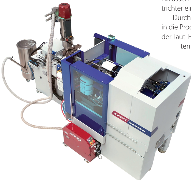
Bild 1. Ingrinder-Systemlösung: Der Angusspicker führt den entnommenen Anguss via Saugförderer der integrierten Mühle zu
